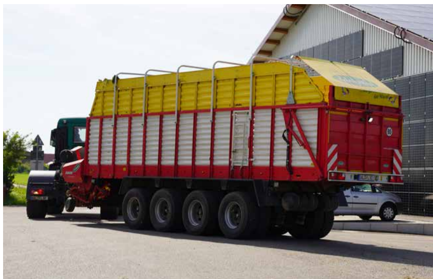
Abb. 2: Aufgrund des großen Einzugsgebiets der Futtertrocknung Lamerdingen eG ist ein autobahntauglicher Fuhrpark von besonders großer Bedeutung. Die Lösung, um diese Anforderung und die Bodenschonung bei der Ernte auf dem Grünland zu kombinieren, sind Unimogs als Zugmaschinen mit 4-Achsladewagen und Zwillingbereifung.
