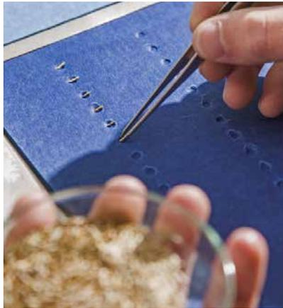
Mit dem Vigor-Test kann die Vitalität des Saatgutes und das Keimwurzelwachstum überprüft werden.
