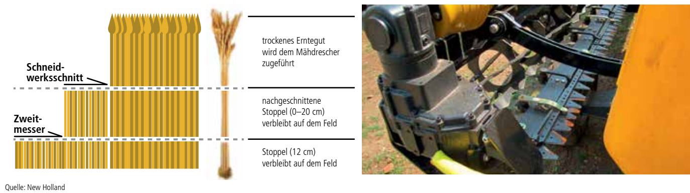
Abb. 1: Dual Stream: Ein zweites Messer schneidet alle Stoppeln auf 15 cm Länge.
