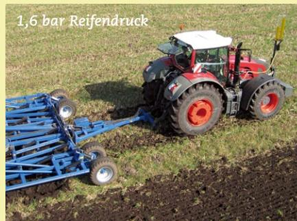
Bei gleicher Arbeit und Fahrweise wird mit weniger Reifendruck der Schlupf verringert und Diesel gespart.
